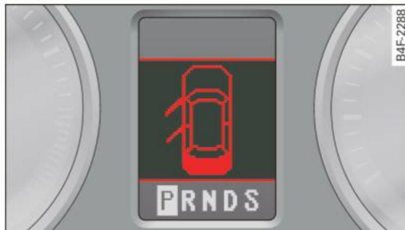
Fig. 12 Display: open door or rear lid warning
