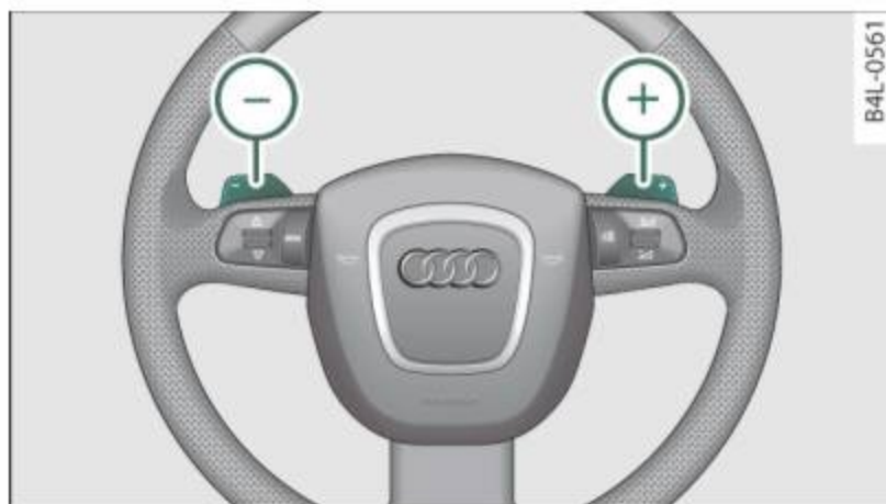
Fig. 155 Steering wheel: Shift buttons
