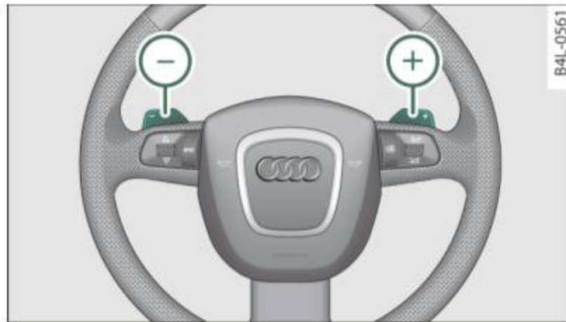
Fig. 163 Steering wheel: Shift buttons
