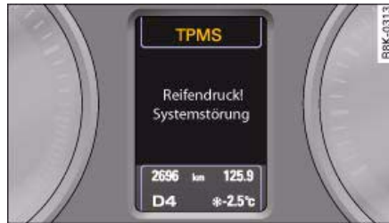
Fig. 28 Display: System fault ("Systemstörung")
